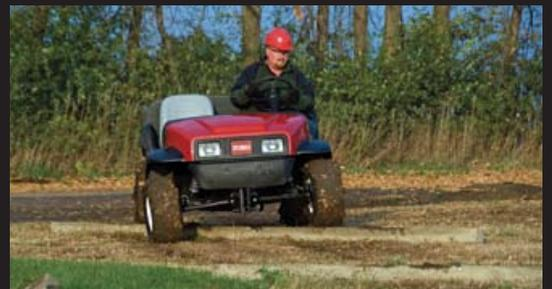
Active In-Frame™ ツイスター・ジョイントにより、すべての車輪がいつも地表に接していますから、アンジュレーションのきつい不整地においても非常に安定した運転制御ができます。
